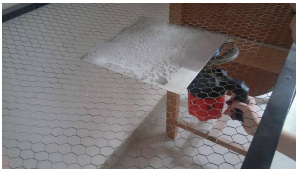
Slika 8 : Fiksiranje asfaltnog praha matrice pomoću plamenika.
