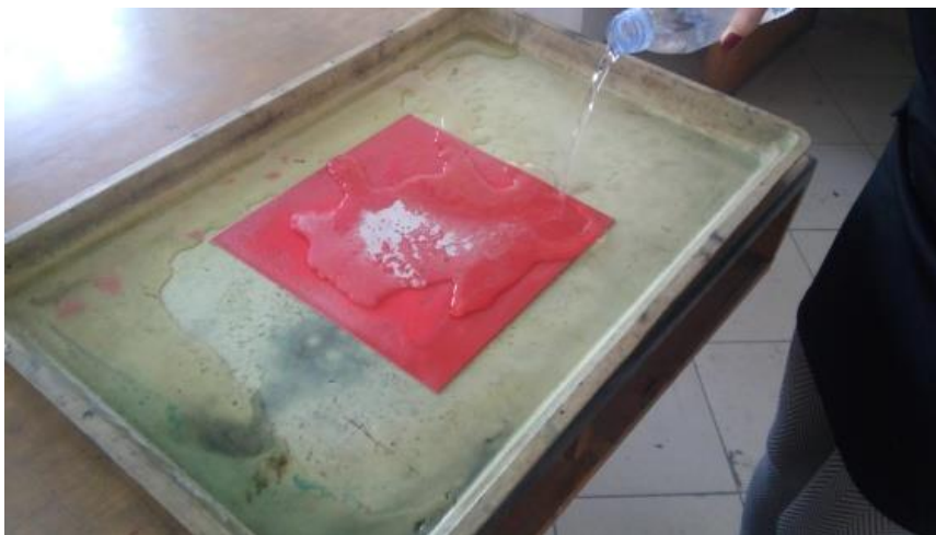
Slika 11: Otapanje soli od autolaka s vodom.
