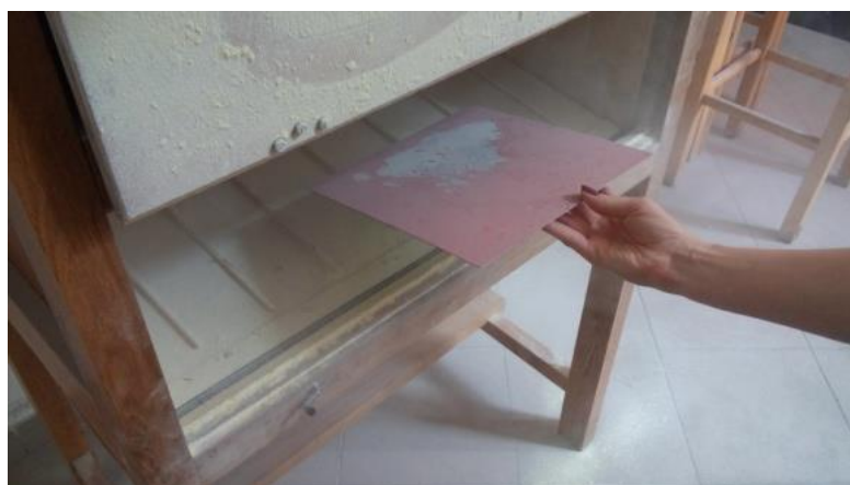
Slika 13 : Uklanjanje matrice iz bubnja za ravnomjerno naprašivanje kolofonijskim prahom.
