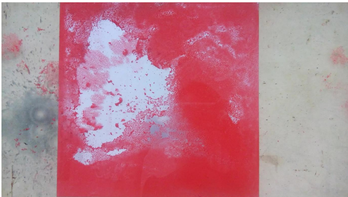
Slika 12: Izgled matrice nakon odvajanja soli od autolaka u vodi.
