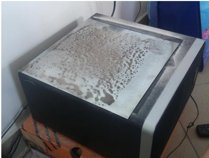
Slika 7: Reprodukcija zvuka i registriranje vibracija.
