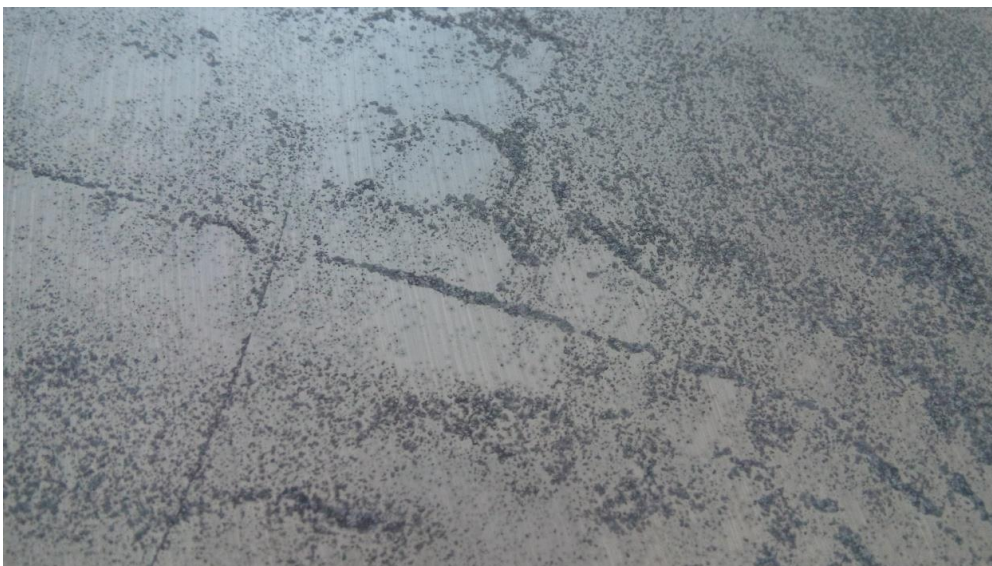
Slika 5 : Rezultat nagrizanja soli, detalj matrice nakon ispiranja vodom ostataka soli.
