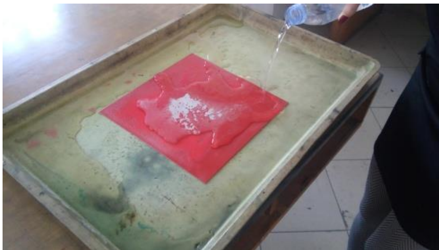
Slika 11: Otapanje soli od autolaka s vodom.
