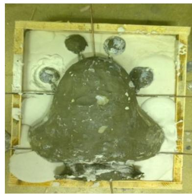
Slika 6. Izrada kalupa
